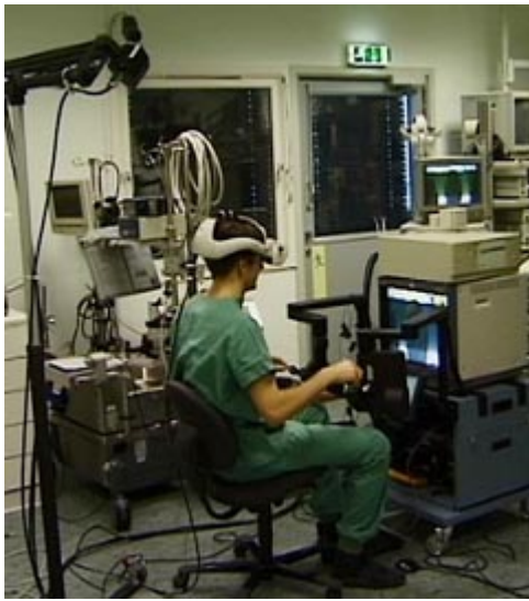
Figur 7 Operasjon med hodesporingsystemet. Tre kameraer over kirurgen monitorerer hodebevegelsene og overfører dem til Aesop-roboten
