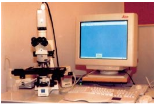
Figur 1 Et videokamera er koblet på et mikroskop og overfører bilder til en datamaskin som viser histologiske bilder og gjør beregninger ved hjelp av et dataprogram
