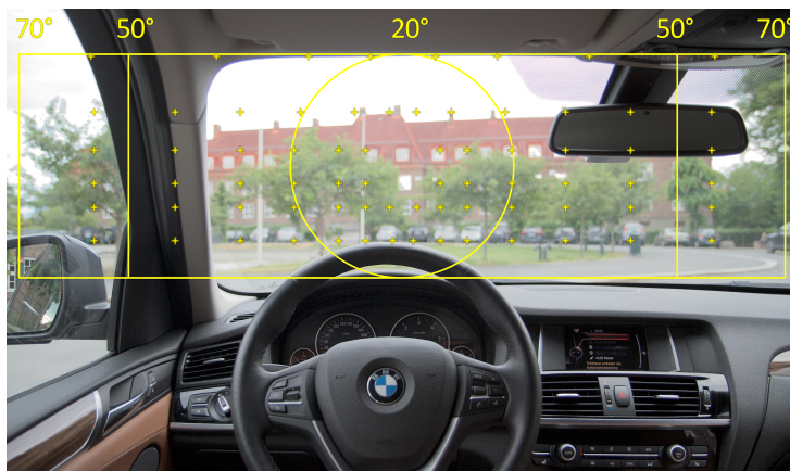
Figur 1 Esterman-programmets målepunkter i et rektangel på 140^{\circ} \times 40^{\circ} projisert på en frontrute fra førerposisjon. Synsfeltet må være minst 50^{\circ} til høyre og venstre, til sammen minst 120^{\circ} og uten utfall i målepunkter i sentrale 20^{\circ} . I resten av rektangelet aksepteres utfall i inntil tre tilliggende målepunkter. Figuren er utarbeidet av forfatterne i samarbeid med Geir Aksel Qvale.
