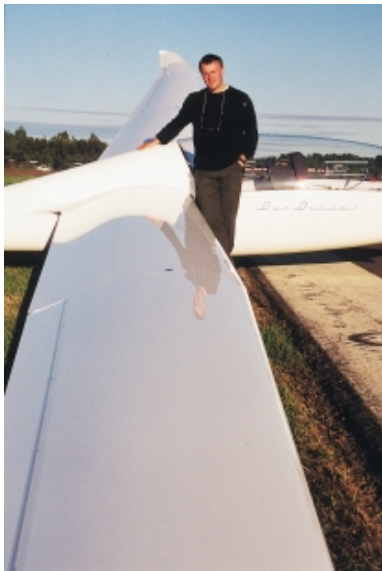
– Dette er «state of the art», sier Anders Rostrup Nakstad stolt om det toseters seilflyet, som har et vingespenn på 20 meter og en vekt på drøyt 400 kg. Begge foto S. Høye
