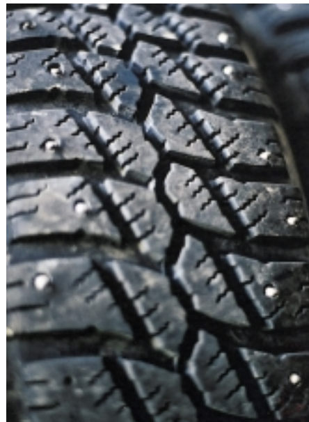
Figur 2 Piggdekk er årsaken til at ca. 250 000 tonn asfalt slites bort årlig
