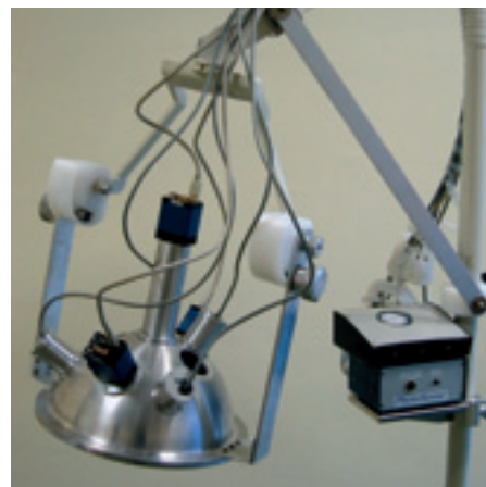
Prototypen av et optisk instrument for bildetaking i forbindelse med hudkreftdiagnostikk. Foto Roy Atle Simonsen
