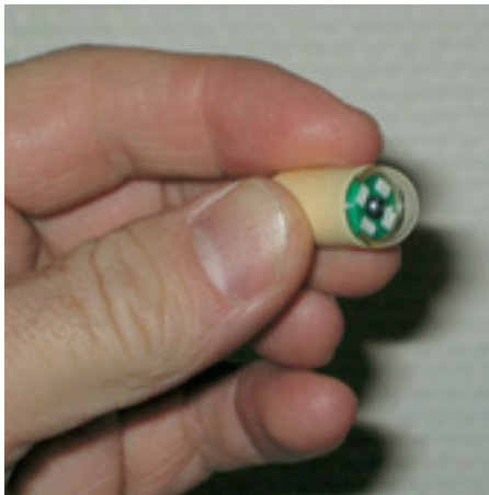
Figur 1 Kapselen måler 11 × 26 mm og svelges med et glass vann
