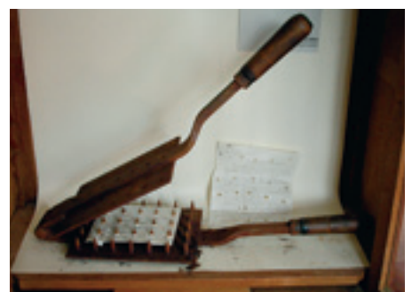
Denne tanga vart brukt til å perforere brev frå område med utbrot av pest. Dei mange hola i breva skulle auke effekten av desinfeksjonsmiddel som vart brukte for å hindre spreiding til nye område. Foto Bjørn Tore Lunestad
