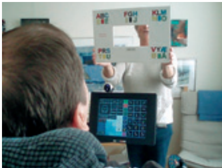
Figur 1 Ofte er kombinasjonen av lavteknologiske og høyteknologiske hjelpemidler nyttig. En pasient i elektrisk rullestol med Rolltalk og skjermtastatur kommuniserer ved hjelp av øyepeketafle
