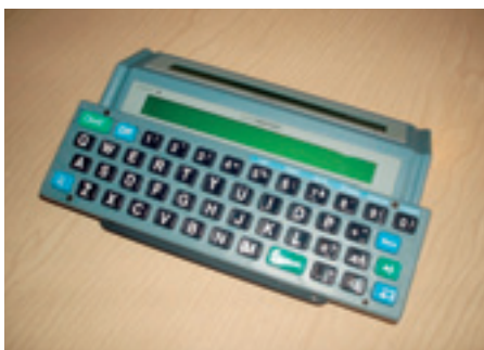
Figur 2 Lightwriter er en bærbar skrivemaskin med skjerm og syntetisk tale som mange pasienter med amyotrofisk lateral sklerose og lammelser i svelg, tunge og gane har nytte av
