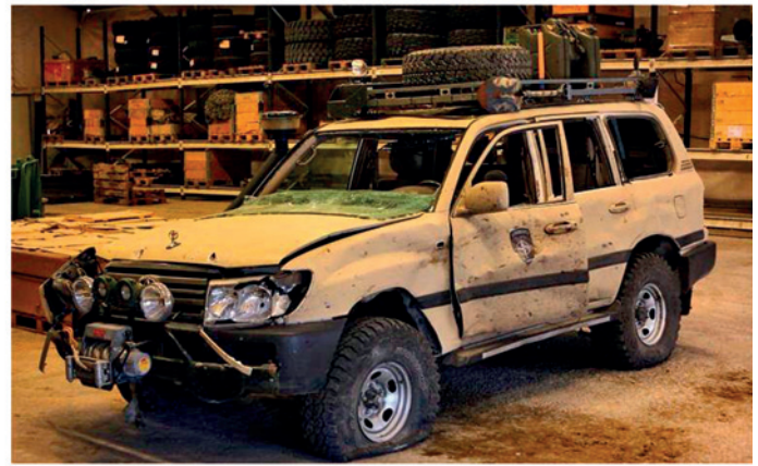
Figur 1 Kjøretøy med ulik grad av pansring som har gått på veibomber. Personskadene kan være store knusninger, sønderrivninger og amputasjoner. Eksplosjonskraftens retning kan være uforutsigbar og avhengig av konstruksjonen av veibomben. Lett skadet og omkommet person kan ha sittet like ved hverandre. Ladningens størrelse og kjøretøys konstruksjon er viktige faktorer når det gjelder skade på personell. a) Eksempel på stor skade på kjøretøy etter veibombe. b) Eksempel på splintskader på kjøretøy etter veibombe. Begge foto Forsvaret
