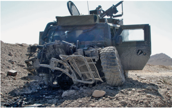
Figur 1 Kjøretøy med ulik grad av pansring som har gått på veibomber. Personskadene kan være store knusninger, sønderrivninger og amputasjoner. Eksplosjonskraftens retning kan være uforutsigbar og avhengig av konstruksjonen av veibomben. Lett skadet og omkommet person kan ha sittet like ved hverandre. Ladningens størrelse og kjøretøys konstruksjon er viktige faktorer når det gjelder skade på personell. a) Eksempel på stor skade på kjøretøy etter veibombe. b) Eksempel på splintskader på kjøretøy etter veibombe. Begge foto Forsvaret
