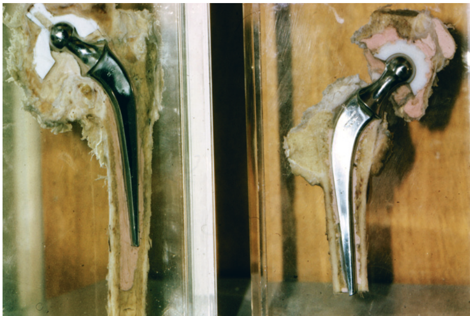
Figur 4 To obduksjonspreparat. Til venstre utsliten teflonhofteskål etter nokre års bruk. Merk vertikal slitasjeveg. Til høgre den framtidsetta protesen med hofteskål av polyetylen med ultrahøg molekylvekt som Charnley tok i bruk i 1962. Fotografert i april 1967 då Sudmann vitja Charnley. Foto: Einar Sudmann
