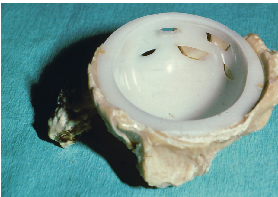
Figur 5 Christiansen-protese revidert ved Kysthospitalet i Hagevik. Delrin-koppen er asymmetrisk sliten tvers igjennom. Denne koppen (utan sementen) nytta Leif Ivar Havelin og medarbeidarar som illustrasjon om slitasje i Christiansen-protesar (25). Slik asymmetrisk koppslitasje går også att i den Christiansen-protesen som Nasjonalt register for leddproteser nyttar som logo. Foto: Einar Sudmann
