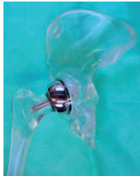
Figur 1 En Birmingham hip resurfacing -skallprotese (Smith and Nephew, Warwick, England), her satt inn i en hoftemodell, har metall-mot-metall-leddflater der «kopp» og «hode» består av en kobolt-krom-molybden-legering med 66 % Co, 26,5–30 % Cr, 4,5–7,0 % Mo, <1 % Ni, Mn og Fe, og <0,35 % C, i henhold til ISO-standard 5832. Bilderrettigheter: Biomatlab, Haukeland universitetssjukehus.
