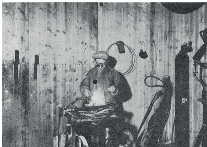
Fra sykkelreparasjonsverksted. Sykkelramme. Autogensveisning.
