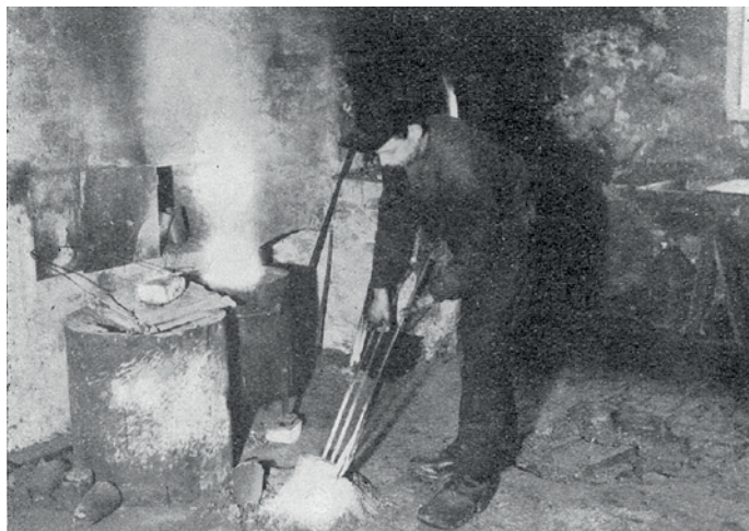
Det smeltede metall i diglen «skummes» for slagg og urenheter.
